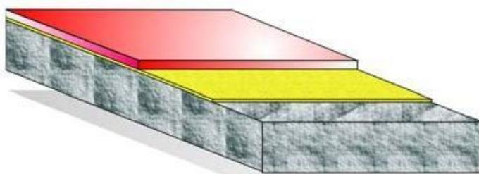
Применяется в закрытых помещениях или на улице с перепадами температур и «сухими» и «влажными» производственными процессами. Повышенная стойкость к абразивным и ударным воздействиям. Температурная стойкость от -40 до +120°C.
