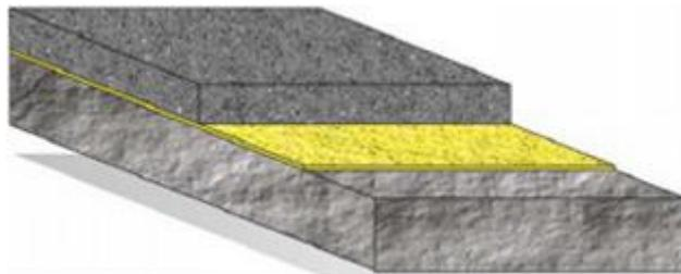
Применяется в закрытых помещениях или на улице с перепадами температур и «сухими» и «влажными» производственными процессами. Повышенная стойкость к абразивным и ударным воздействиям. Температурная стойкость от -40 до +120°C
