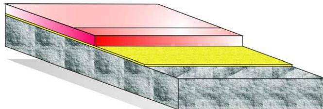
Применяется в закрытых помещениях или на улице с перепадами температур и «сухими» и «влажными» производственными процессами. Повышенная стойкость к абразивным и ударным воздействиям. Температурная стойкость от -40 до +120°C.
